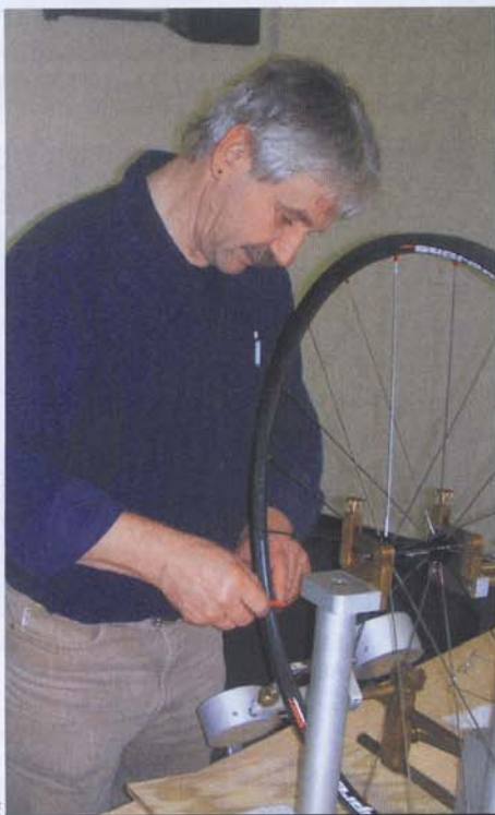
Viel Handarbeit steckt in den Laufrädern von Supreme. Sorgfältiges Zentrieren soll für gleichbleibend guten Rundlauf sorgen
